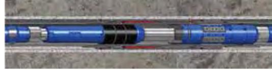
**Рисунок 6 – Расположение активационного ключа для открытия/закрытия муфты ГРП**
